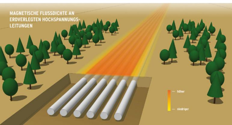
sind die Werte bei Erdkabeln ab einem gewissen seitlichen Abstand zur Trasse daher geringer als bei Freileitungen. Erdkabel stören das Landschaftsbild weniger als Freileitungen. Allerdings muss auch bei Erdkabeln ein breiter Korridor von Bewuchs freigehalten werden, damit
