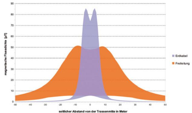
**Wertebereiche von an unterschiedlichen Freileitungs- und Erdkabeltrassen der Höchstspannungsebene gemessenen und auf maximale Betriebsbedingung (maximaler Strom) extrapolierten magnetischen Flussdichten.**
