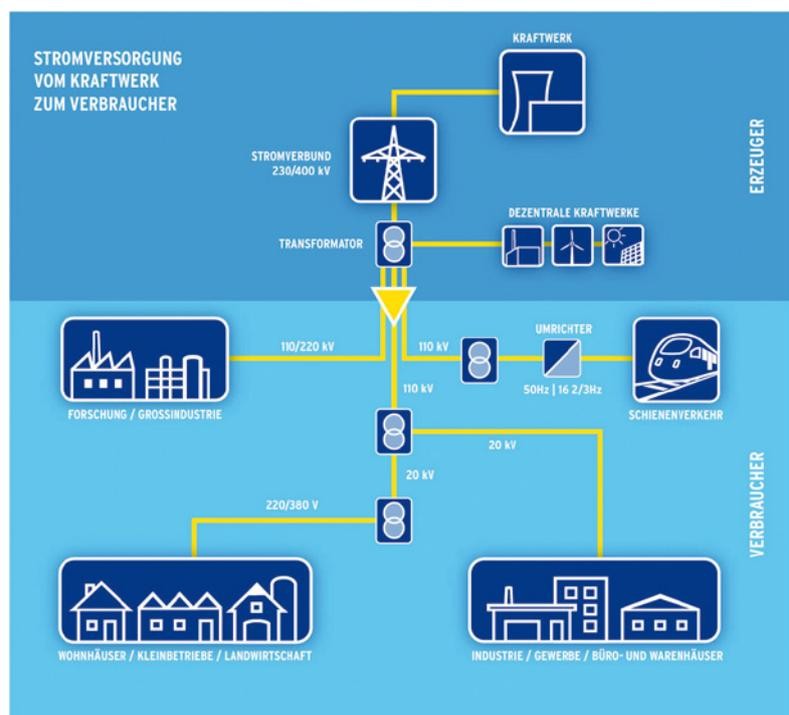
Hohe Spannungen sind für die Übertragung elektrischer Energie günstiger als niedrige, weil bei hohen Spannungen weniger Energie durch Leiterwiderstände verloren geht. Allerdings lässt sich die Höhe der Spannung nicht unbegrenzt steigern. Die Spannung auf einer Leitung wird daher jeweils nach der Länge der Übertragungsstrecke und der bei den Stromempfängern benötigten Leistung ausgewählt.
